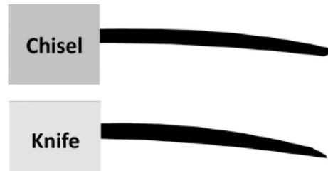
図4 ChiselおよびKnifeのレンズエッジ形状
